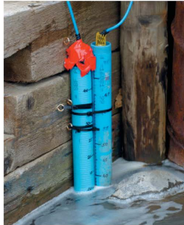
Sonda multiparamétrica en la estación BCAA
