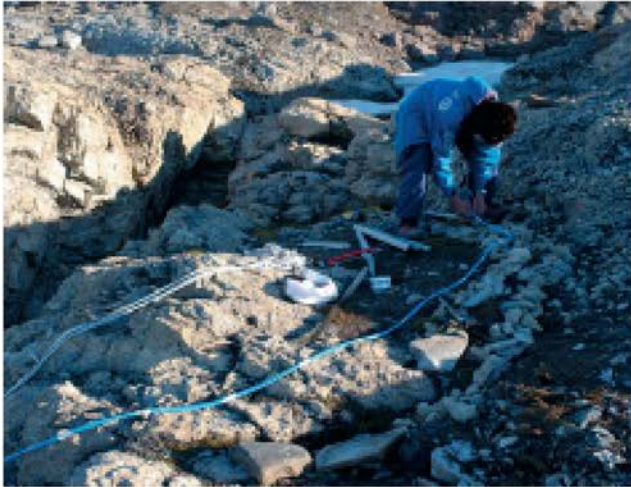
Protegiendo el cable de las sondas instaladas
